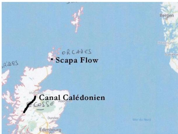
Construit entre 1804 et 1822, il est long de plus de 96 kilomètres, en partie sur des glens naturels et en partie (35 km) sur des canaux avec 29 écluses. L'objectif était de permettre à la flotte de Nelson de prendre la flotte de Napoléon par surprise en prenant ce raccourci à travers les terres.
